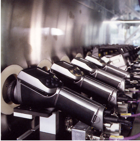
Rysunek 18.5 PO LEWEJ: Testowanie kamer termowizyjnych w komorze klimatycznej; PO PRAWEJ: Robot do testowania i kalibracji kamer
