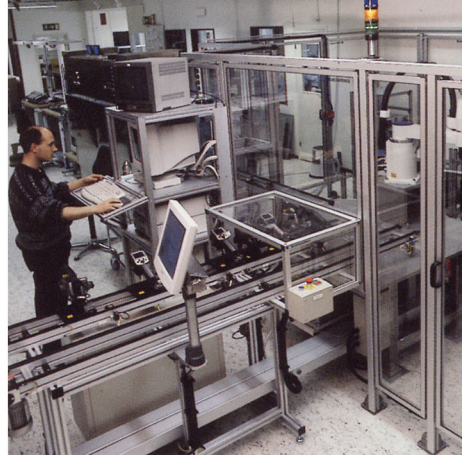
Rysunek 18.5 PO LEWEJ: Testowanie kamer termowizyjnych w komorze klimatycznej; PO PRAWEJ: Robot do testowania i kalibracji kamer
