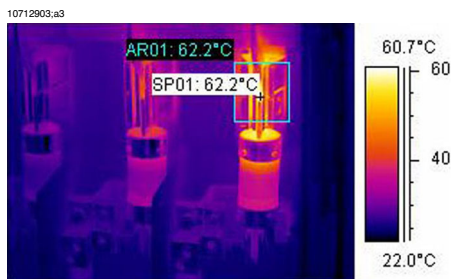
Rysunek 17.3 Termowizyjny obraz skrzynki bezpieczników z pokazaną temperaturą maksymalną.
