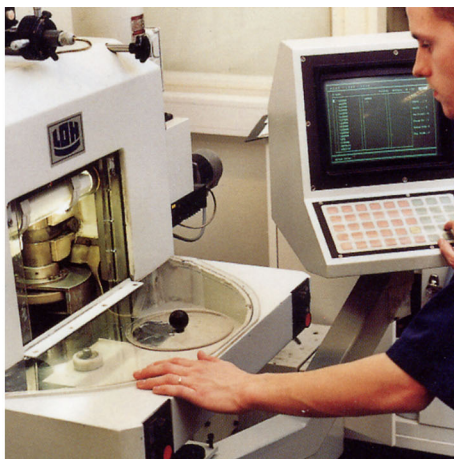
Rysunek 18.4 PO LEWEJ: Tokarka diamentowa; PO PRAWEJ: Polerowanie soczewki
